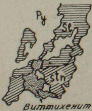
Фиг. 2. М-ние Танзут, шл. № 5/55. Выделения станнина (stn) и виттихенита в тесном срастании со сфалеритом (Sl) в полях пирита (Py).  $\times 706$ .
