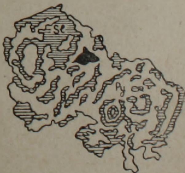
Фиг. 1. М-ние Танзут, шл. № 4/55. Формы выделения сфалерита (Sf) в пирите (Py). X 353.
